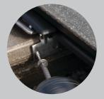
Klammern mit den mitgelieferten Schrauben am Konstruktionsbalken fixieren. Schraube <u>nicht</u> festziehen.
